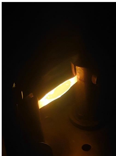
Рисунок 5. Молибденовая лодочка с гранулой алюминия
