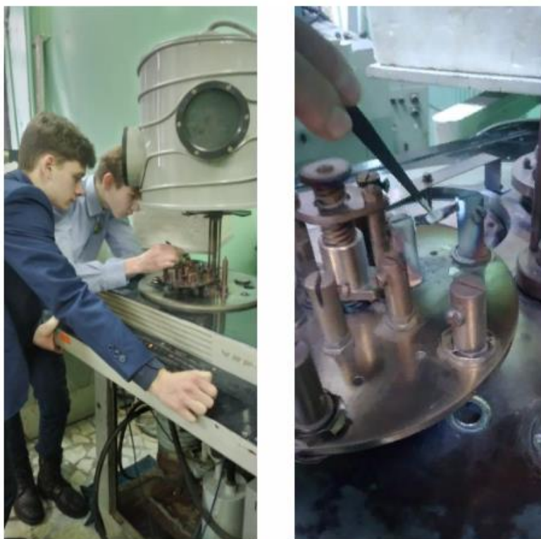
Рис.1. Укомплектование вакуумной системы Далее мы опустили купол, и в работу вступил насос низкого вакуума (Рис. 2).
