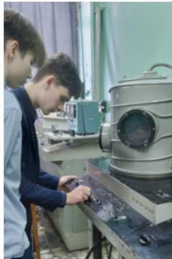
Рис. 2. Начало откачки воздуха и напыления Конструкция форвакуумного насоса изображена на рисунке 3.
