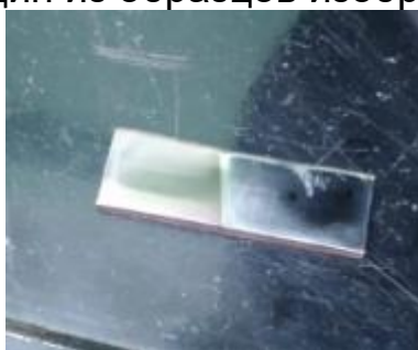
Рис. 6. Слева на образце видна область с напыленным алюминием.
